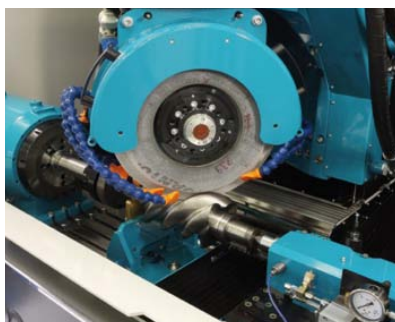
Produkcja bloków śrubowych
