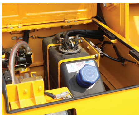
POMPA NAPEŁNIANIA PALIWA
